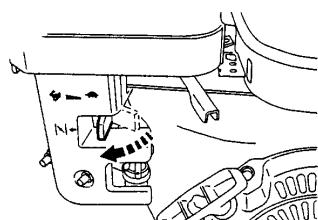
4. スロットルレバーを低速位置②から高速位置③の方向に1/3位開いた位置にします。
