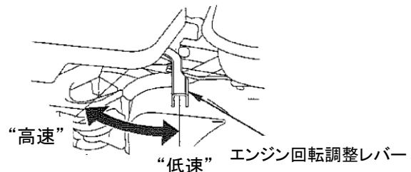
※本機の運転は必ずエンジン回転調整レバーを“高速”的位置で運転してください。
