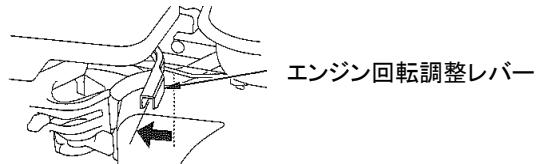
5. 作業機側の安全な部分をしっかりと押さえ、始動グリップを静かに引き、重くなるところでとめます。次に矢印方向に強く引っ張ります。
