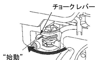
4. エンジン回転調整レバーを矢印の方向に少し動かします。
