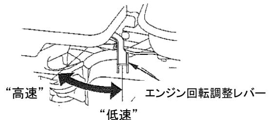
※本機の運転は必ずエンジン回転調整レバーを“高速”的位置で運転してください。
